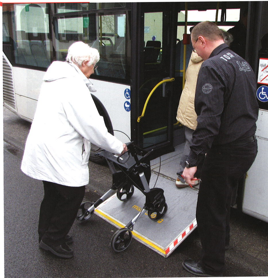
Einstieg in den Bus mit Rollator mittels der „Klappe“. SeniorenNetzwerk Ostheim.
